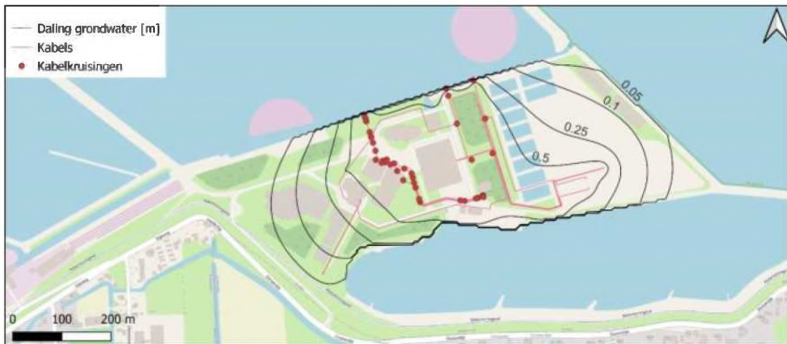
Afbeelding 4.5 Verlaging freatische grondwaterstanden door bemaling door gelijktijdige aanleg van alle kabels/leidingen en hun kruisingen
