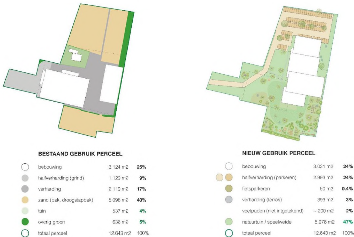
Figuur 6.1 Schematische weergave van de huidige situatie (links) en de nieuwe situatie (rechts).
